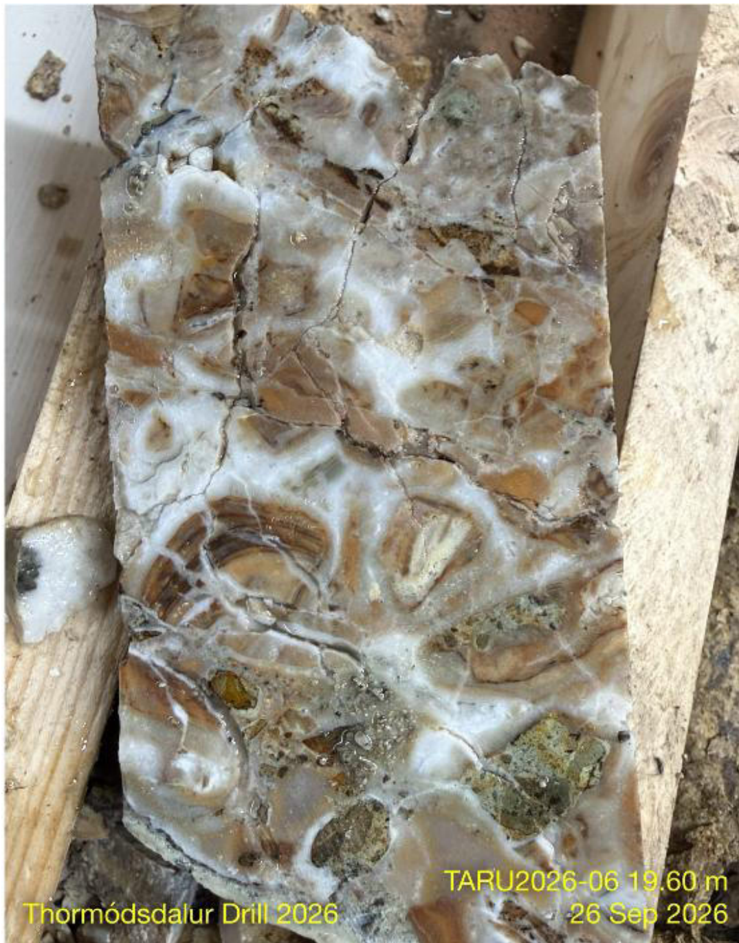
Abbildung 4: Brekzierte Quarz-Adularia-Aderklasten in einer hydrothermalen Brekzie, die durch später entstandenen Chalcedon und feinkristallinen Quarz zementiert ist. Der Kerndurchmesser beträgt 68 mm.
