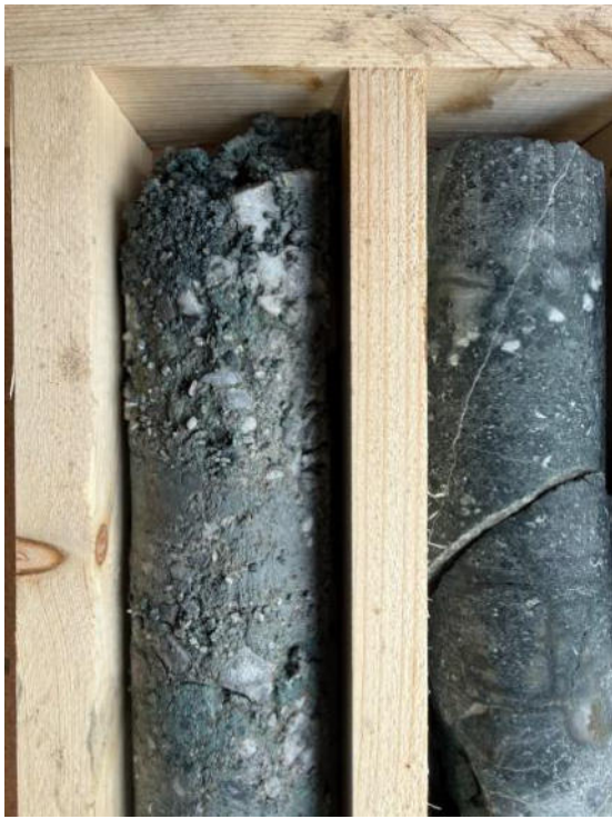
Abbildungen 1 (links) und 2 (rechts): Epithermale Quarzadern, die durch Verwerfungsbewegungen nach der Mineralisierung aufgebrochen und brekziiert wurden. Der epithermale Charakter ist in den Fragmenten deutlich erkennbar. Die Tonmasse kann feinkörnigen Pyrit enthalten. Der Kerndurchmesser beträgt 68 mm.
