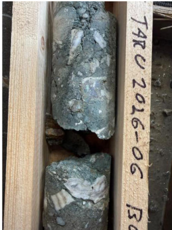
Abbildungen 1 (links) und 2 (rechts): Epithermale Quarzadern, die durch Verwerfungsbewegungen nach der Mineralisierung aufgebrochen und brekziiert wurden. Der epithermale Charakter ist in den Fragmenten deutlich erkennbar. Die Tonmasse kann feinkörnigen Pyrit enthalten. Der Kerndurchmesser beträgt 68 mm.
