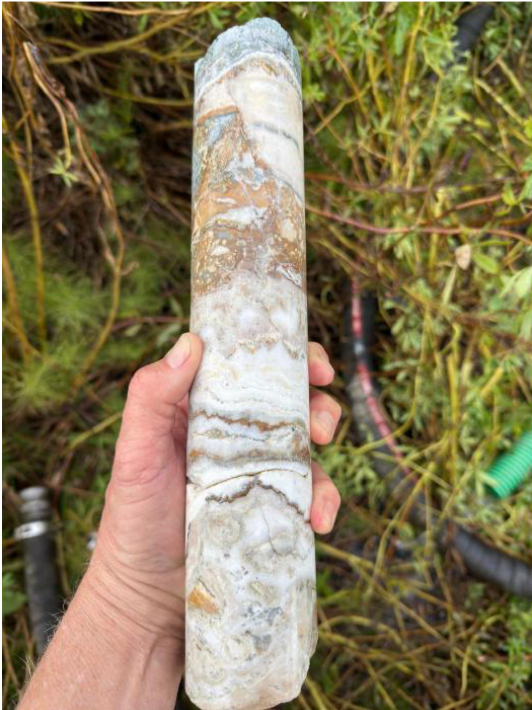
Abbildung 3: „Klassische“ intakte epithermale Quarzader mit rhythmischer Kolloform-Bänderung und mehreren Zonen hydrothermaler Brekziierung. Der Kerndurchmesser beträgt 68 mm.
