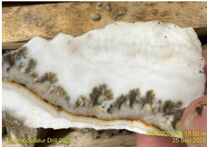
Abbildung 5 (links): Dunkle Bänderung im Quarz. Abbildung 6 (rechts): Moosstruktur in feinkörnigem Siliziumdioxid.
