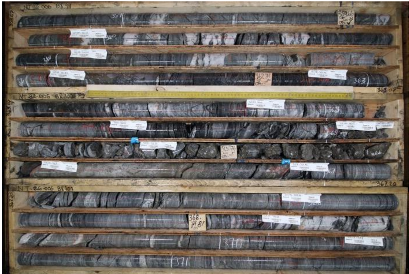
Abbildung 9: Zonen brekzierten und verheilten Gesteins im Bohrloch NT-26-006. Verheilte Brekzien und zugehörige Scherzonen können auf langlebige, großräumige Strukturen hindeuten, die als Fluidwege für regionale Mineralisierungssysteme dienen können.
