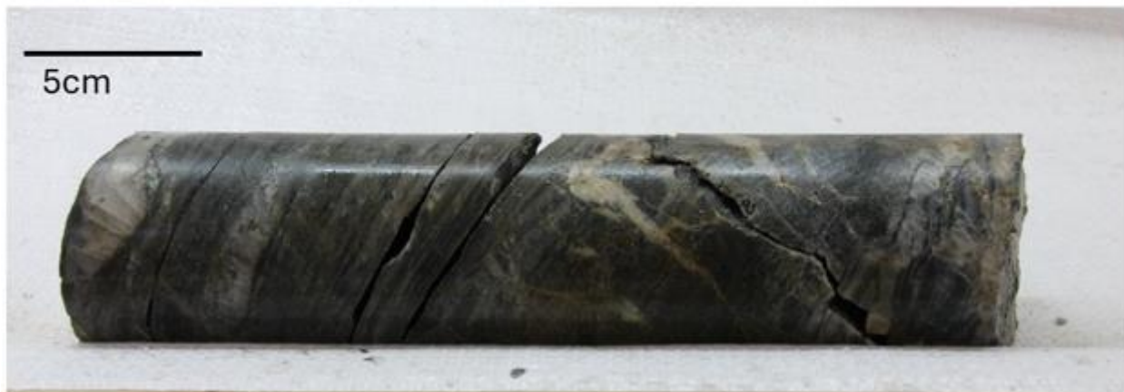
Abbildung 5: Potenziell mineralisierte Abschnitte aus Bohrloch NT-26-006: Oben – 36,2–36,7 m – Extensionsquarzader mit sichtbarem Gold, Wismut-Sulfosalzen, Arsenopyrit und Pyrit. Mitte – 40,9–41,2 m – Extensionsquarzader mit sichtbarem Gold, Wismut-Sulfosalzen, Pyrrhotin und Pyrit. Unten – 41,9–42,2 m – lokale Quarzscheradern und Extensionsquarz-Karbonatadern in Verbindung mit Kalksilikat-Alteration sowie Pyrrhotin-, Arsenopyrit- und Pyrit-Sulfidverdrängung kalkhaltiger metasedimentärer Gesteine.
