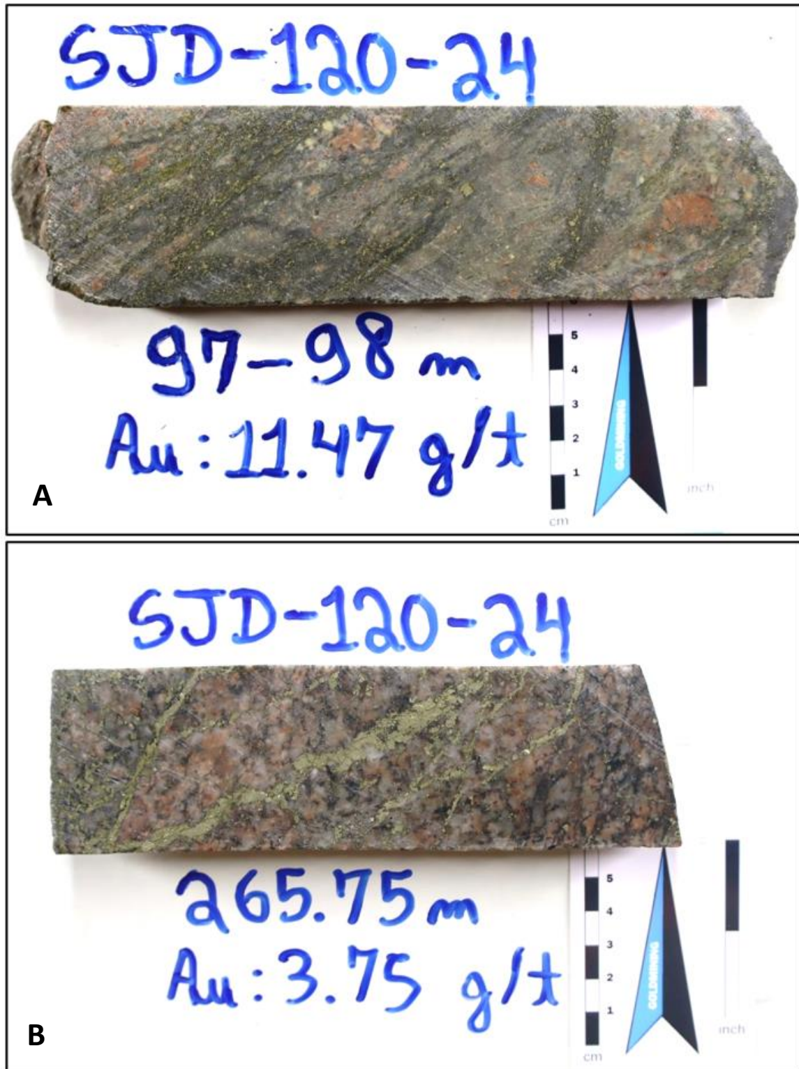
Abbildung 4 - Goldmineralisierung auf São Jorge aus Bohrloch SJD-120-24: (A) 11,47 g/t Au aus 97,0 bis 98,0 m Bohrloch, bestehend aus stark mit Pyrit durchzogenem und verkieseltem/brekziösem Monzogranit; und (B) 3,75 g/t Au aus 265,0 bis 266,0 m
