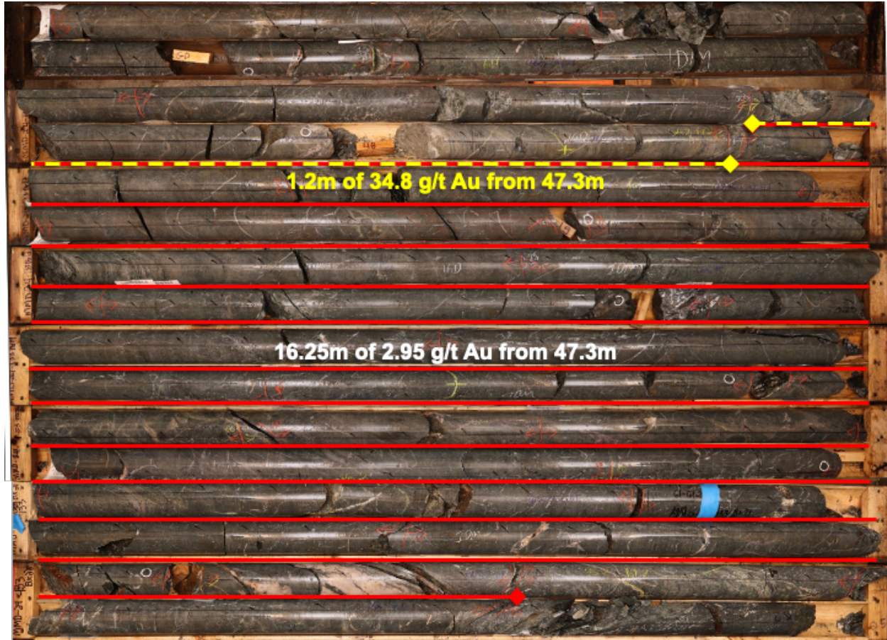
Abbildung 3: Zeigt den Bohrkern von Bohrloch MMD-24-133, der durch eine gestapelte Abfolge von hochgradigen Scherflächen innerhalb eines alterierten Granodiorits gekennzeichnet ist, der 16,25 m mit 2,95 g/t Au von 47,3 bis 66,55 m ergab.
