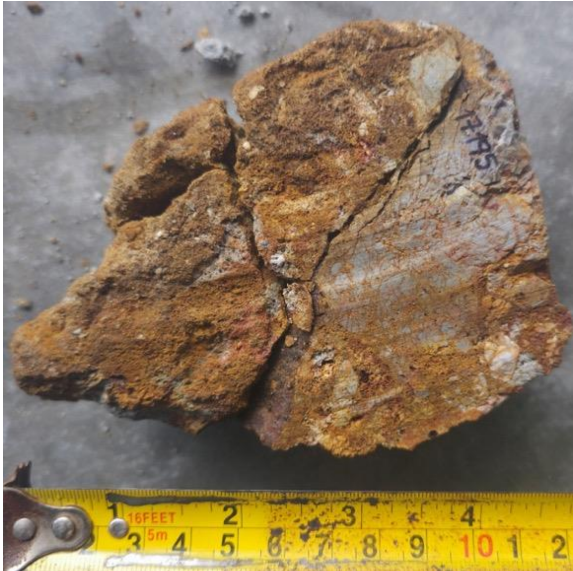
Abbildung 4: Polymiktische mineralisierte Brekzienprobe mit einem Gehalt von 7,1 g/t Au aus dem Kanal CH17191 (96,5 m mit 0,6 g/t Au) im Bereich Previsto Central, die kantige Klaster in einem oxid-nach-sulfidhaltigen Zement aus Kalifeldspat, Quarz und Karbonat zeigt – eine für das alkalische porphyir-epithermale System charakteristische Textur.
