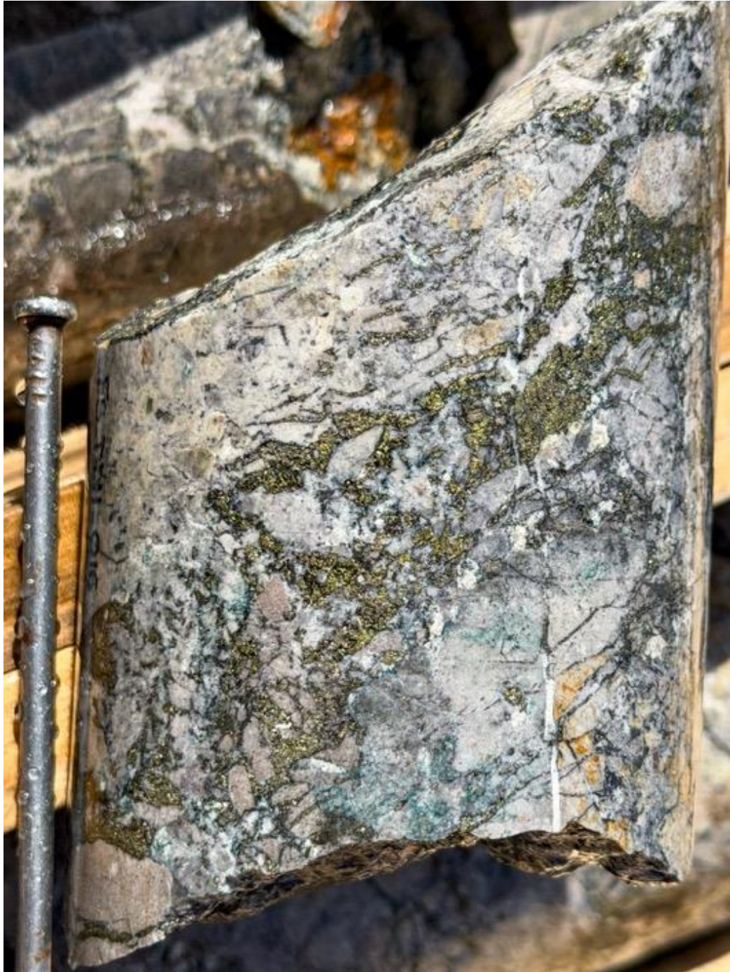
Abbildung 1: Bohrkern aus 125,75 m (FS_DD_H_016), 125–126 m mit Gehalten von 1,67 % Cu, 1,62 g/t Au, 1,69 g/t Ag, 685 ppm Mo
