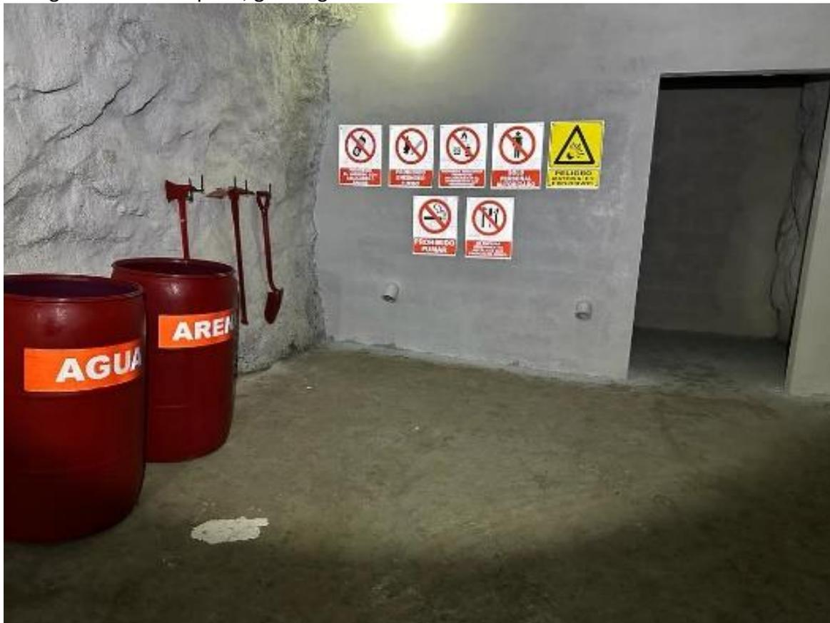
Abbildung 1: Untertägiges Pulvermagazin
