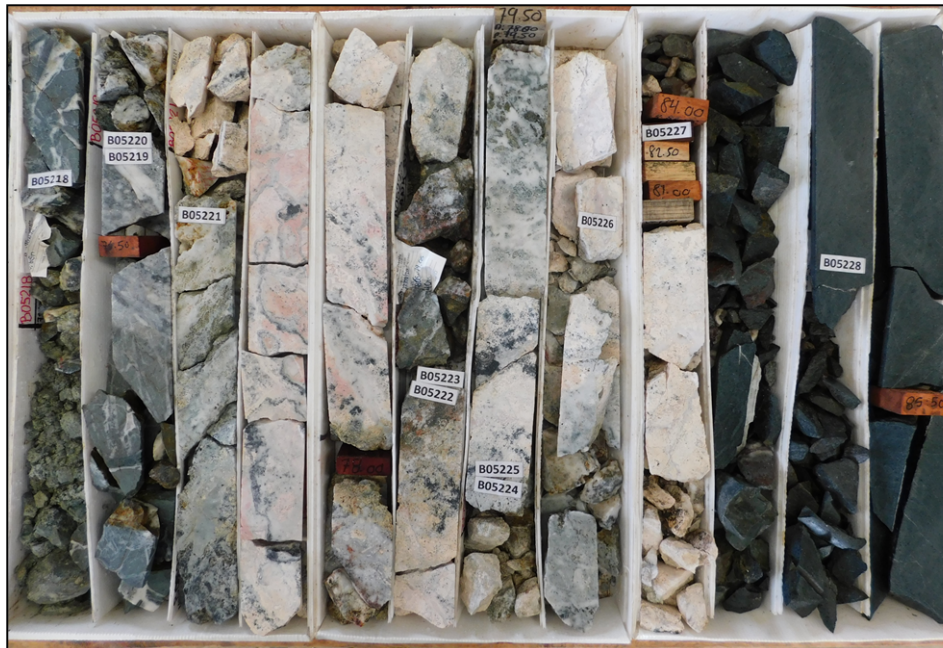
Abbildung 2: Bohrkern durch Gang in Bohrung CS-20-01, Erzgang Tajitos.
