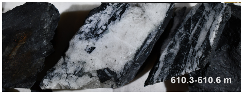
Foto 1: Quarz-Karbonat-Chlorit-Chlorit-Graphit, geädert innerhalb der Zone der Serizit-Pyrit-Chlorit-Alteration (aus dem Probenintervall 610,3-610,6 Meter).
