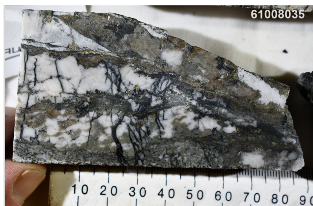
Foto 4: Bruchkontrollierte Biotit-Serizit-Pyrit-Alteration mit Spuren von Chalkopyrit in Verbindung mit Quarz-Karbonat-Adern aus dem Probenintervall 832,1-832,5 Meter.
